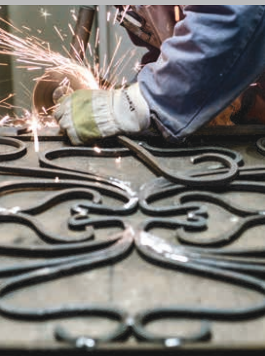
Detail: De roosters V-160 worden vervaardigd uit massief smeedijzer en vervolgens thermisch verzinkt.
